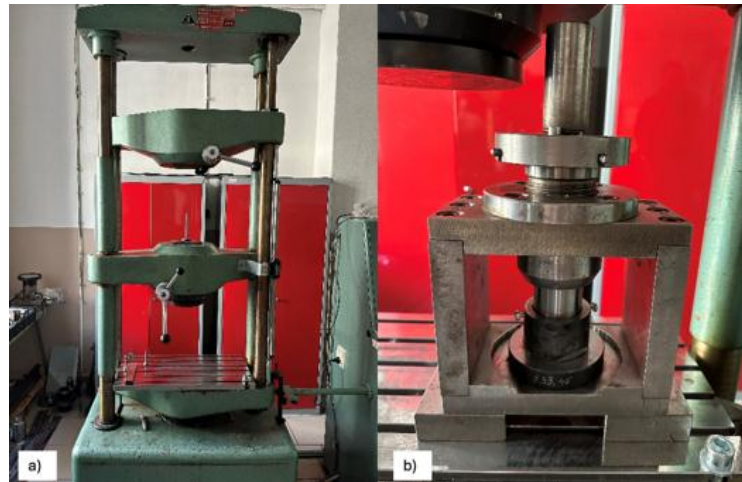
Fig. 2 a) Hydraulic press ZD40, b) drawing tool
